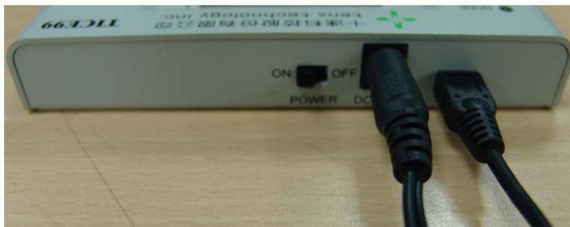
圖(2-2) TICE99 電源及 USB 連接圖示
